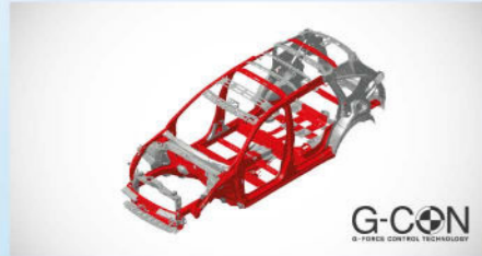
โครงสร้างตัวถังบิรภัย G-CON และ ACE™ ปกป้องห้องโดยสารจากการชนรอบทิศทาง
