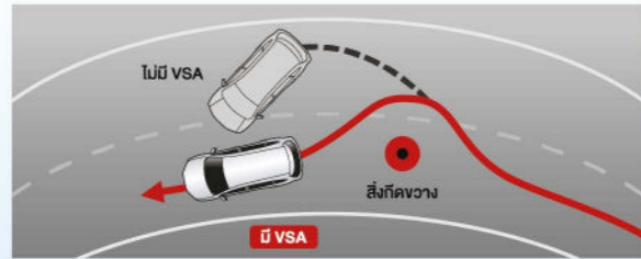
Vehicle Stability Assist (VSA) ระบบช่วยควบคุมการทรงตัวขณะขับขี่
