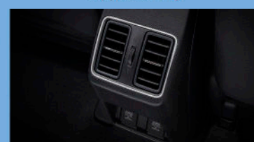
ระบบปรับอากาศแถวหลัง พร้อมช่องจ่ายไฟสำรอง 2 ตำแหน่ง
