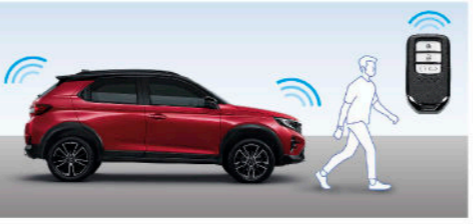
Walk Away Auto Lock ระบบล็อกอัตโนมัติเมื่อถูกเซนเซอร์ไม่ทอยูห่างจากตัวรถ
