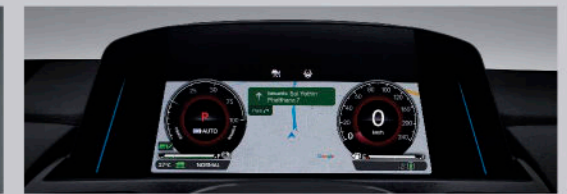
10.2" TFT Multi-information Display มาตรวัด พร้อมหน้าจอแสดงข้อมูลการขับขี่แบบ TFT ขนาด 10.2 นิ้ว
